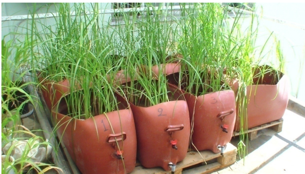
Σχήμα 16: Τεχνητοί υγρότοποι επιφανειακής ροής που κατασκευάσθηκαν στα πλαίσια του έργου PhotoWetSun.
