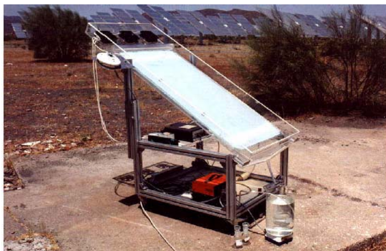
Σχήμα 8.27 : Φωτοκαταλυτικός αντιδραστήρας ηλιακού φωτός σταθερής κλίσης.
