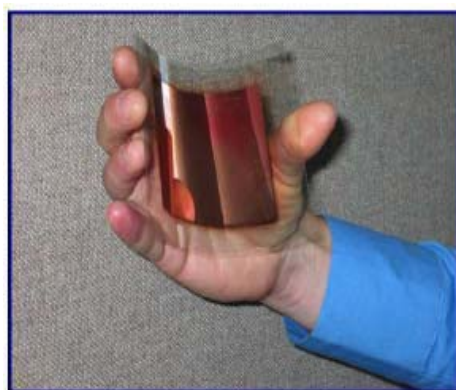
Σχήμα 9.10: Φωτοβολταϊκά ηλιακά κύτταρα με πολυμερή ημιαγώγιμα υλικά.
